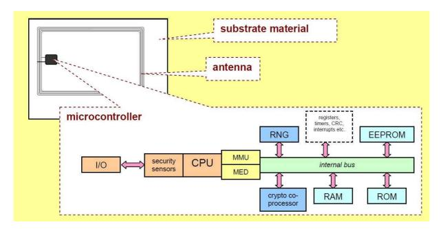
Les composants sont divisés en un ensemble de sous-systèmes avec les différentes couches du logiciel embarqué :
